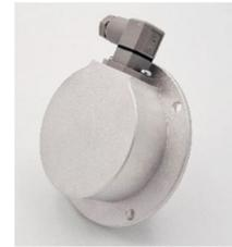
Die Drehstrom-Drehzahlgeber dienen der Erzeugung einer der Drehzahl proportionalen sinusförmigen Dreiphasenspannung oder über einen eingebauten Drehstrombrückengleichrichter einer Gleichspannung, deren Polarität von der Drehrichtung unabhängig ist. Wegen der geringen Welligkeit der Ausgangsgleichspannung sind sie besonders als Istwertgeber für Drehzahlregelungen geeignet.
