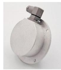
Die Drehstrom-Drehzahlgeber dienen der Erzeugung einer der Drehzahl proportionalen sinusförmigen Dreiphasenspannung oder über einen eingebauten Drehstrombrückengleichrichter einer Gleichspannung, deren Polarität von der Drehrichtung unabhängig ist. Wegen der geringen Welligkeit der Ausgangsgleichspannung sind sie besonders als Istwertgeber für Drehzahlregelungen geeignet.
